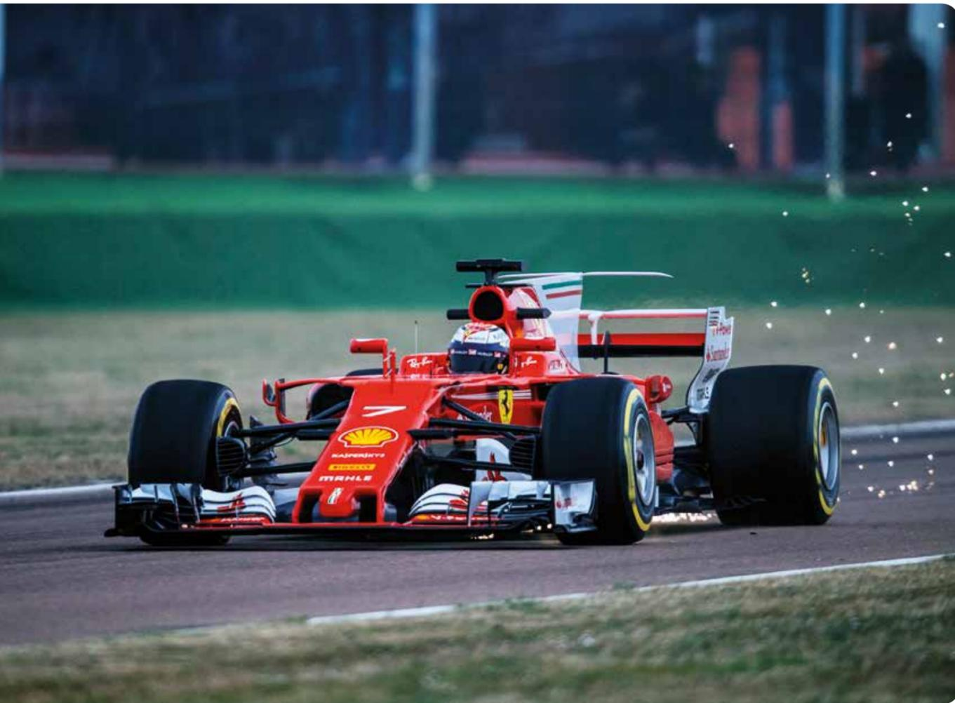
Por otra parte, el bargeboard que monta el SF70-H es de menor complejidad que los montados tanto por Renault o Mercedes, sin embargo, el trabajo realizado en esta parte del monoplaza es evidente, con unos direccionadores de flujo muy extensos que recorren una buena parte del pontón. Para finalizar, la toma de refrigeración superior, colocada encima de la cabeza del piloto es muy convencional y similar a la del monoplaza de 2016.
