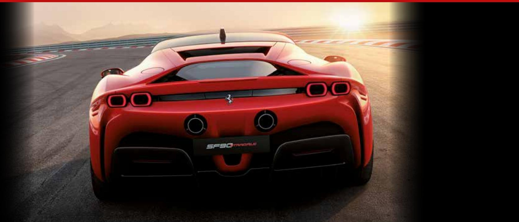
En términos de diseño, la cubierta del motor del SF90 Stradale se ha mantenido extremadamente baja para mejorar la interacción entre los flujos, sobre y debajo del cuerpo, y así minimizar el arrastre.
