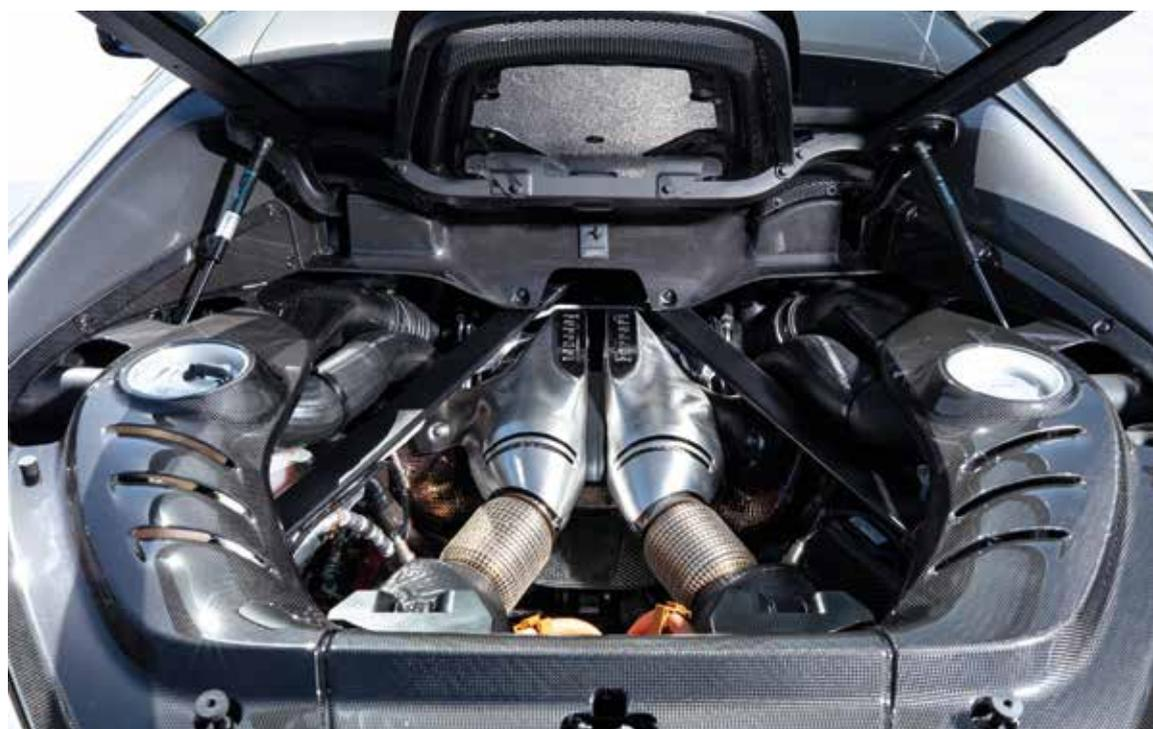
La arquitectura del tren motriz está compuesta, además del V6 turbo y la caja de cambios DCT de 8 velocidades ya vista en SF90 Stradale, Ferrari Roma, Ferrari Portofino M y SF90 Spider, por la unidad eléctrica MGU-K en eje con el motor térmico colocada entre motor y caja de cambios. A ello se le añade el actuador TMA para desacoplar la máquina eléctrica y el motor térmico, la batería de alto voltaje con una capacidad de 7,45 kWh, y el inversor destinado a la gestión de los motores eléctricos.
