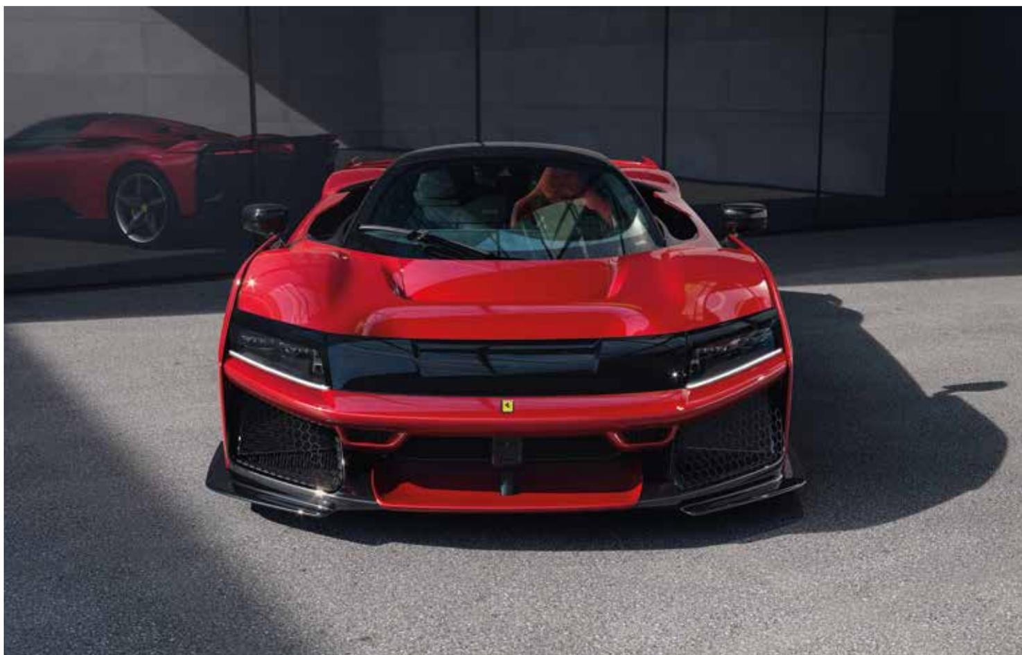
aprovechar el espacio entre la parte inferior y el grupo óptico, mientras que el tercero está colocado horizontal y centralmente y trabaja con el *upwash* generado por el triplano para asegurar el correcto flujo de aire.
